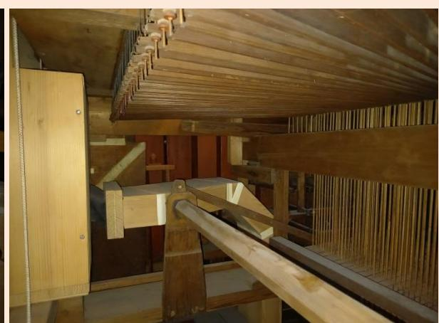
De toets- en registertraktuur werd op ambachtelijke wijze vervaardigd met houten walsen en raamwerken, abstracten en draadwerk. De moeren zijn van leder. Tussen het hout en leer is cloth aangebracht, invoeringen zijn deels van kernlaken voorzien.
