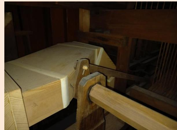
De ventilator werd in 2000 binnen de orgelkas geplaatst. De originele pomplijninstallatie is nog aanwezig maar wordt niet meer gebruikt.
